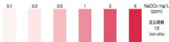
標準色〈亜塩素酸ナトリウム(低濃度)〉 Standard Color 〈 Sodium Chlorite (Low Range) 〉
